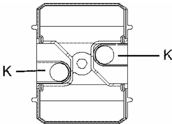
Pour les câbles d'un diamètre de plus de 10 mm, nous recommandons d'ouvrir les entrées de câbles (K) dans le couvercle aux endroits indiqués avec une pince coupante après le placement des conducteurs
