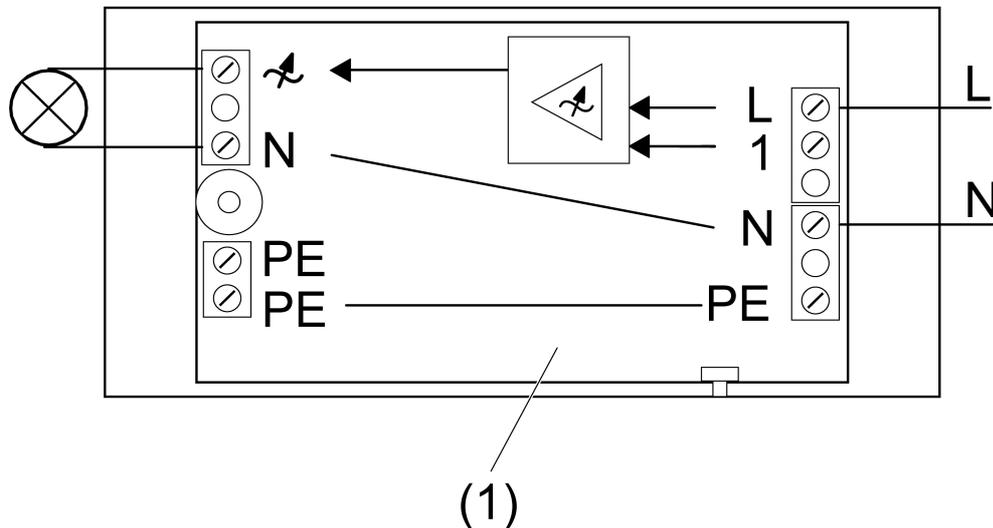
Figure 3: Schéma de raccordement du variateur à fil
