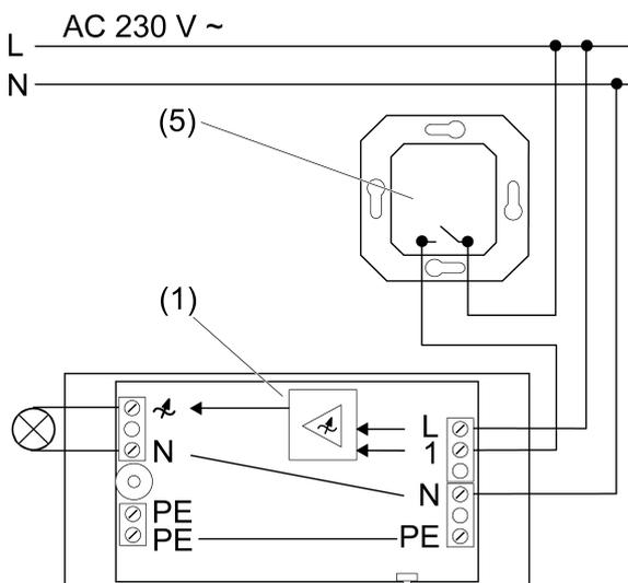
Figure 5: Schéma de raccordement du variateur à fil avec poussoir d'installation
