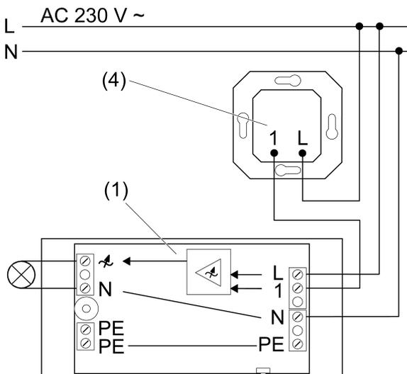
Figure 4: Schéma de raccordement du variateur à fil avec poste auxiliaire bifilaire
