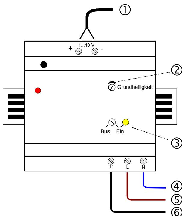
Effectuer la connexion conformément à la figure ci-contre.
