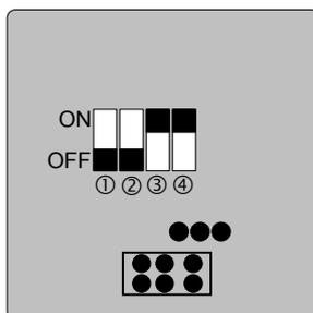
Die Kanaluordnung des 4Kanal-Handsenders bzw. die Gruppenzuordnung beim 8Kanal-Handsenders werden auf der Rückseite des IR-Steuertasters eingestellt (Bild II).
