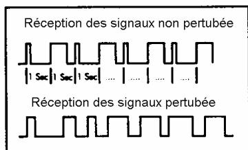
Si le montage et le raccordement ont été effectués correctement, voir les exemples en page 5, une impulsion est captée toutes les secondes par l'antenne. Cette impulsion est signalée par la LED et peut durer 100 ms ou 250 ms.
