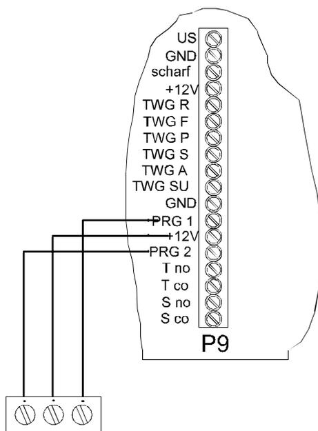
Bild 2: Anschlussschema LED-Statusanzeige
