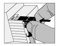
Pour enlever le recouvrement, bouger latéralement et retirer (fig. C).
