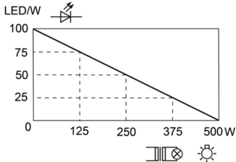
Figure 4: Courbe de charge des charges mixtes
