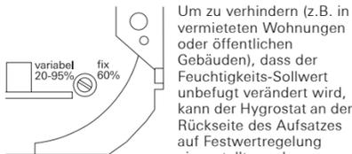
Um zu verhindern (z.B. in vermieteten Wohnungen oder öffentlichen Gebäuden), dass der Feuchtigkeits-Sollwert unbefugt verändert wird, kann der Hygrostat an der Rückseite des Aufsatzes auf Festwertregelung eingestellt werden.
