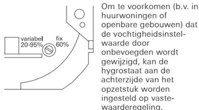
Om te voorkomen (b.v. in huurwoningen of openbare gebouwen) dat de vochtigheidsinstelwaarde door onbevoegden wordt gewijzigd, kan de hygrostaat aan de achterzijde van het opzetstuk worden ingesteld op vaste-waarderegeling.
