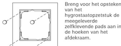
Breng voor het opsteken van het hygrostaatoepzetstuk de meegeleverde zelfklevende pads aan in de hoeken van het afdekraam.
