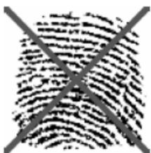
le capteur scanne alors uniquement l'empreinte digitale dans la partie supérieure du bout du doigt, donc trop loin au-dessus du centre des tourbillons. On y trouve nettement moins de lignes courbes et le système ne peut ainsi le cas échéant déterminer que trop peu de caractéristiques significatives.
