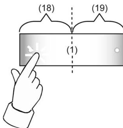
Bild 19: Beispiel für eine Tastenbetätigung bei konfigurierter Zweiflächenbedienung
