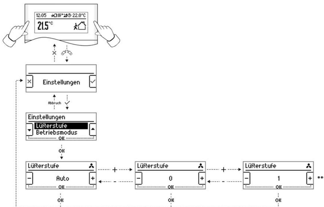
Bild 10: Beispiel für das Untermenü der manuellen Lüftersteuerung
