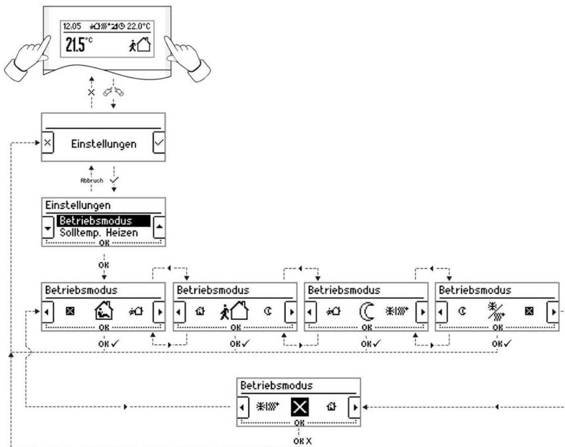
Bild 11: Beispiel für das Untermenü der Betriebsmodusumschaltung
