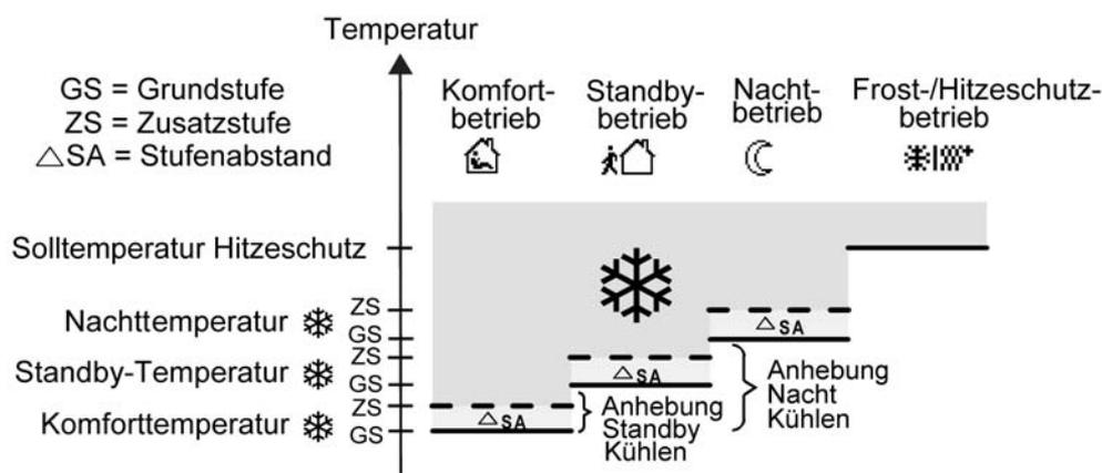
Bild 45: Solltemperaturen in der Betriebsart "Grund- und Zusatzkühlen"
