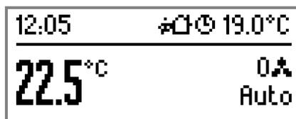
Bild 65: Beispiel für eine Lüfterstufenanzeige im Automatikbetrieb
