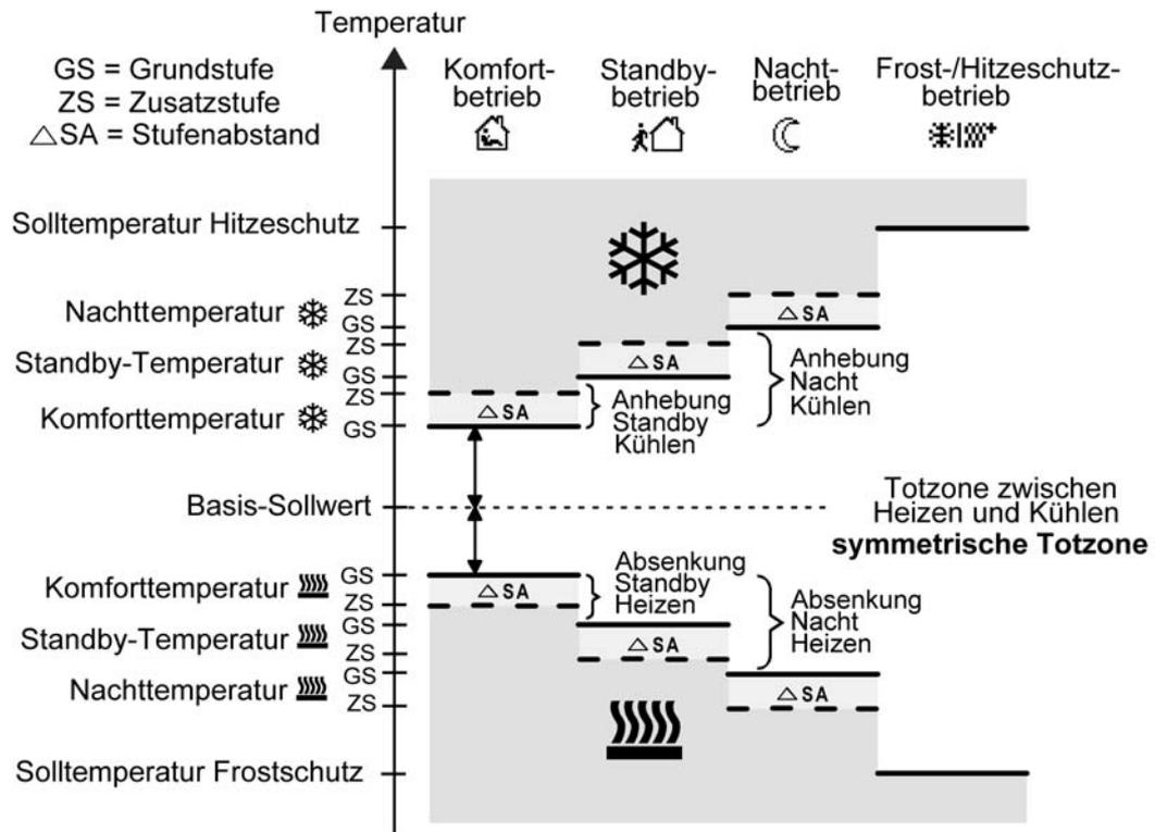
Bild 48: Solltemperaturen in der Betriebsart "Grund- und Zusatzheizen und -kühlen" mit symmetrischer Totzone
