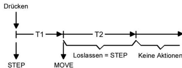
Bild 21: Bedienkonzept "Kurz-Lang-Kurz"
