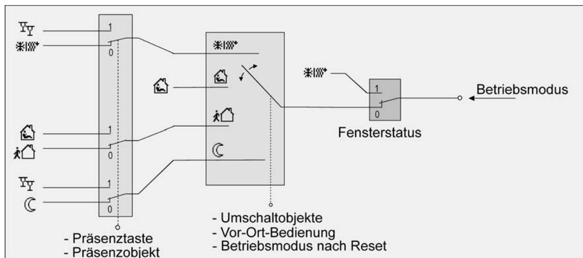
Bild 38: Betriebsmodusumschaltung durch 4 x 1 Bit Objekte mit Präsenztaste
