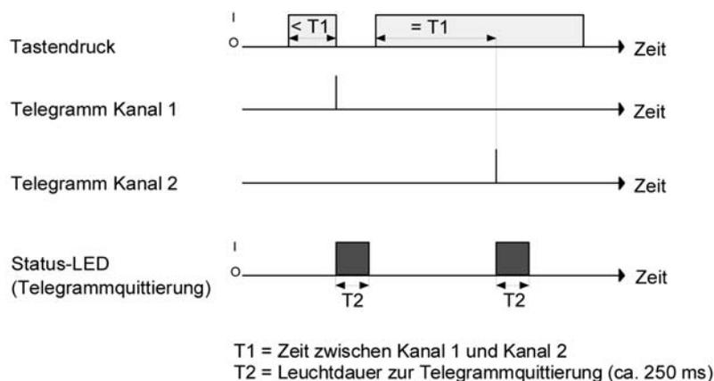
Bild 27: Beispiel zum Bedienkonzept "Kanal 1 oder Kanal 2"
