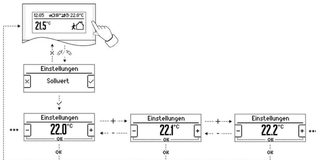
Bild 8: Menübedienung zur Sollwertverschiebung
