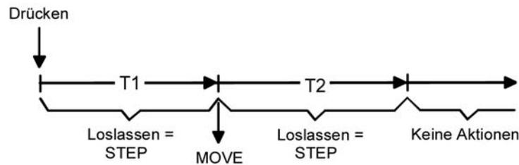
Bild 24: Bedienkonzept "Lang – Kurz oder Kurz"
