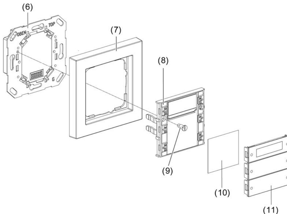
Bild 2: Gerätemontage eines Tastsensor 3 plus 2fach
