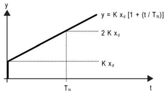
Bild 36: Funktion der Stellgröße einer PI-Regelung
