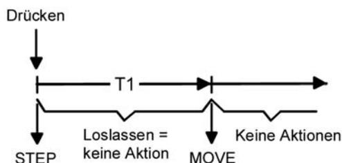
Bild 23: Bedienkonzept "Kurz - Lang"
