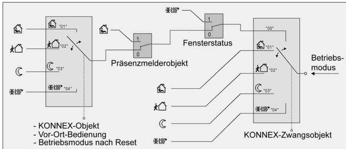
Bild 41: Betriebsmodusumschaltung durch KONNEX Objekt mit Präsenzmelder
