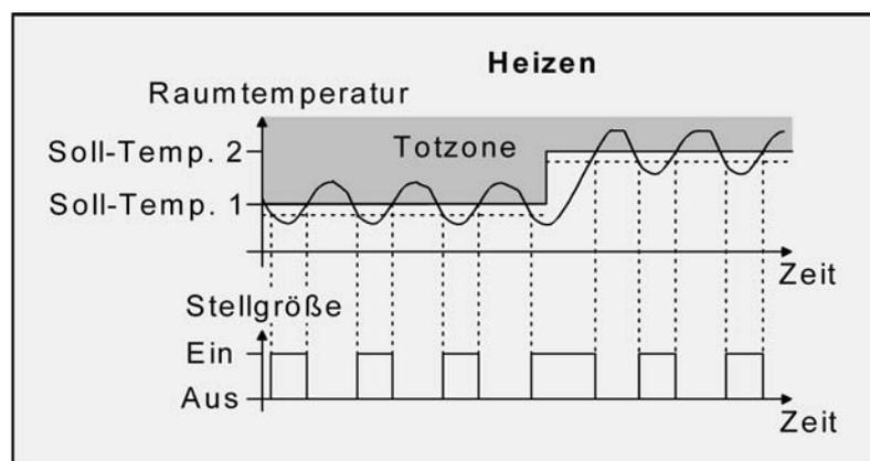
Bild 34: 2-Punkt-Regelung für Mischbetriebsart "Heizen und Kühlen" bei aktivem Heizbetrieb
