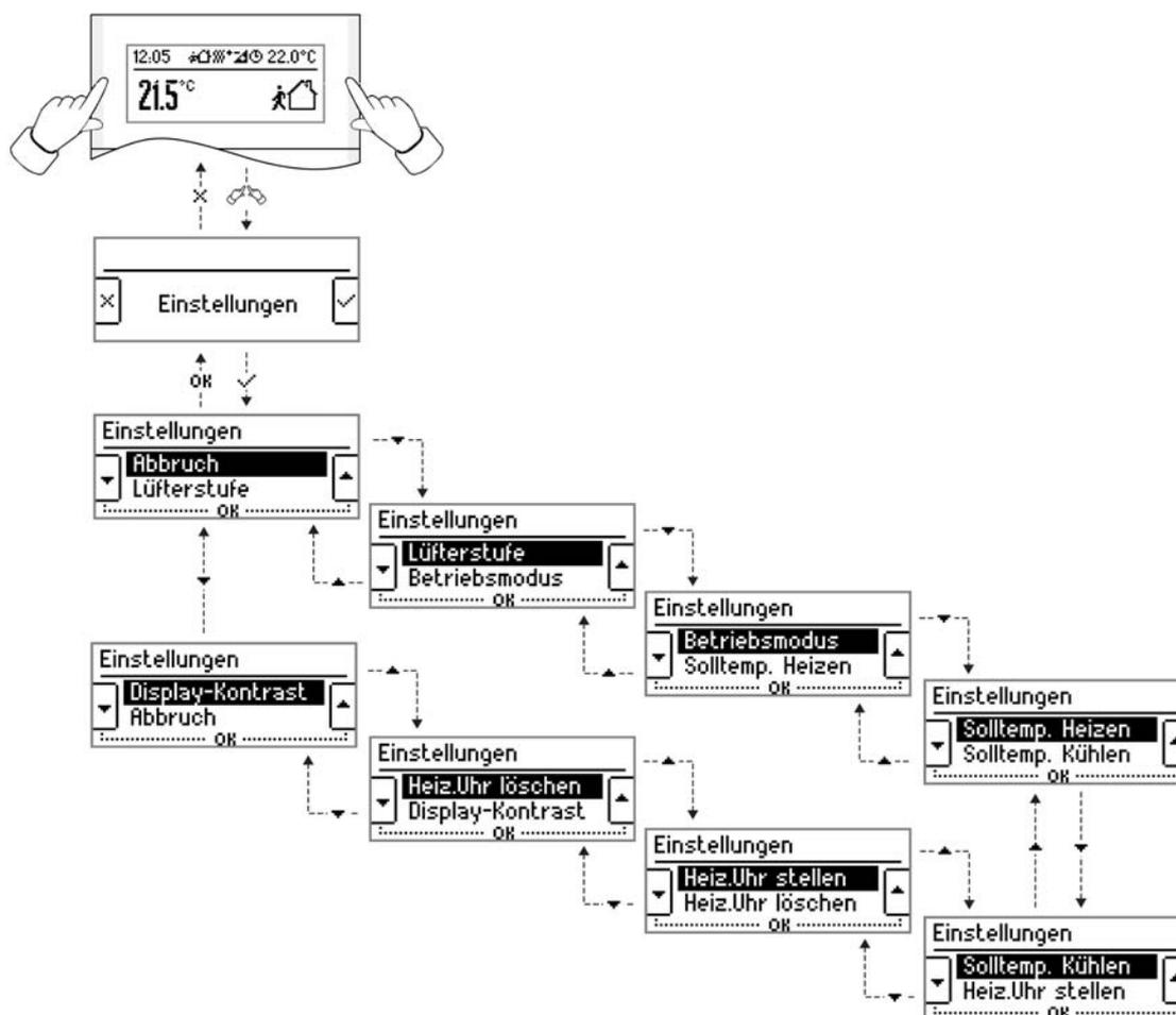
Bild 9: Navigation durch das Hauptmenü der Geräteeinstellungen
