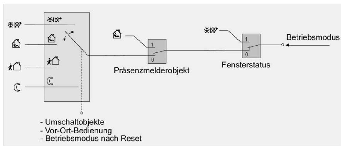
Bild 39: Betriebsmodusumschaltung durch 4 x 1 Bit Objekte mit Präsenzmelder
