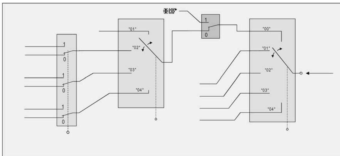
Bild 40: Betriebsmodusumschaltung durch KONNEX Objekt mit Präsenztaste
