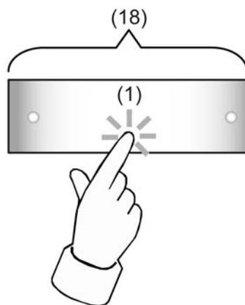
Bild 20: Beispiel für eine Tastenbetätigung bei konfigurierter Einflächenbedienung
