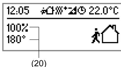
Bild 54: Beispiel einer 2-Bereichs-Anzeige mit 2-zeiliger Wertanzeige
