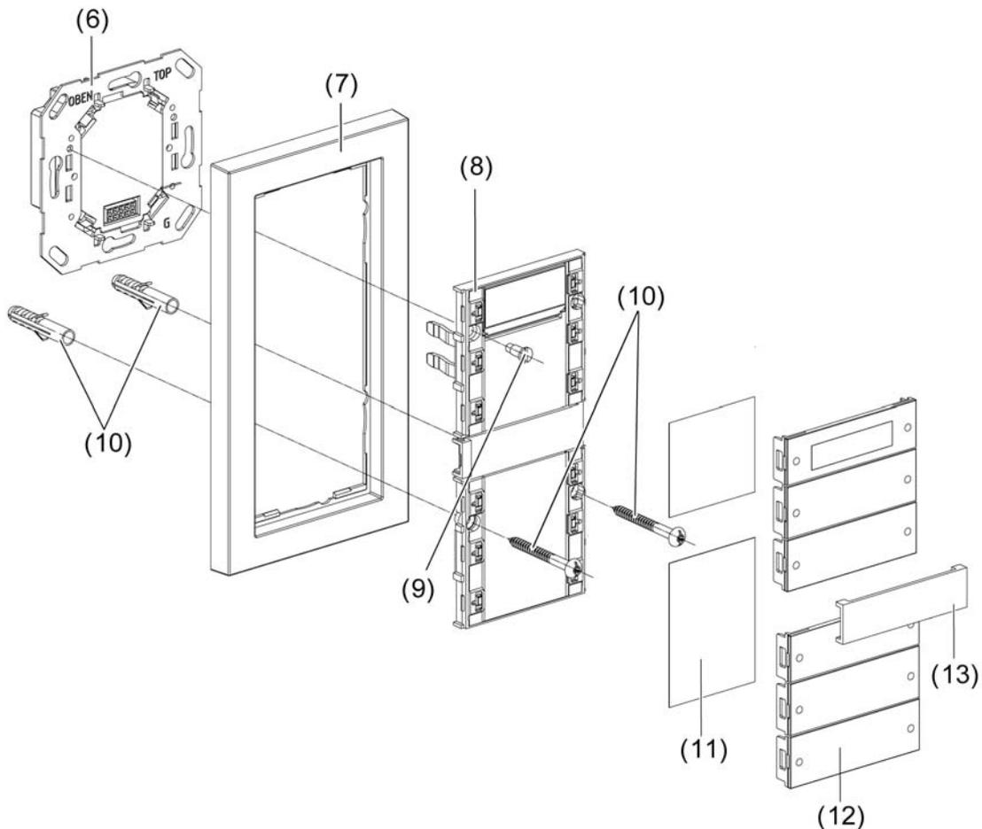
Bild 3: Gerätemontage eines Tastsensor 3 plus 6fach (doppelte Höhe)
