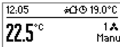
Bild 66: Beispiel für eine Lüfterstufenanzeige im manuellen Betrieb
