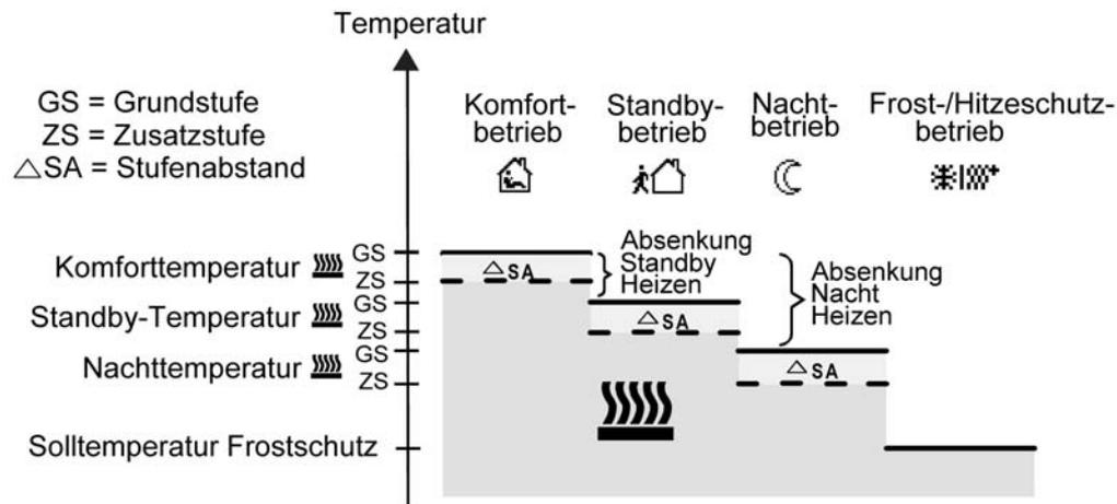
Bild 43: Solltemperaturen in der Betriebsart "Grund- und Zusatzheizen"
