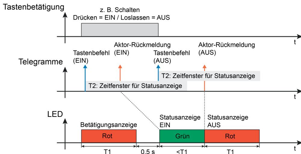
Bild 6: Beispiel einer 2-stufigen Betätigungs- und Statusanzeige mit Doppelstatus
