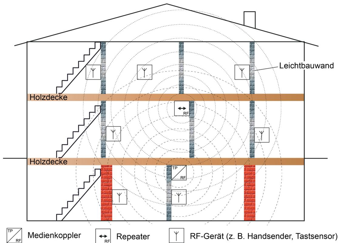
Bild 34: Gebäudestruktur mit einer KNX RF Linie und Repeater (Beispiel)
