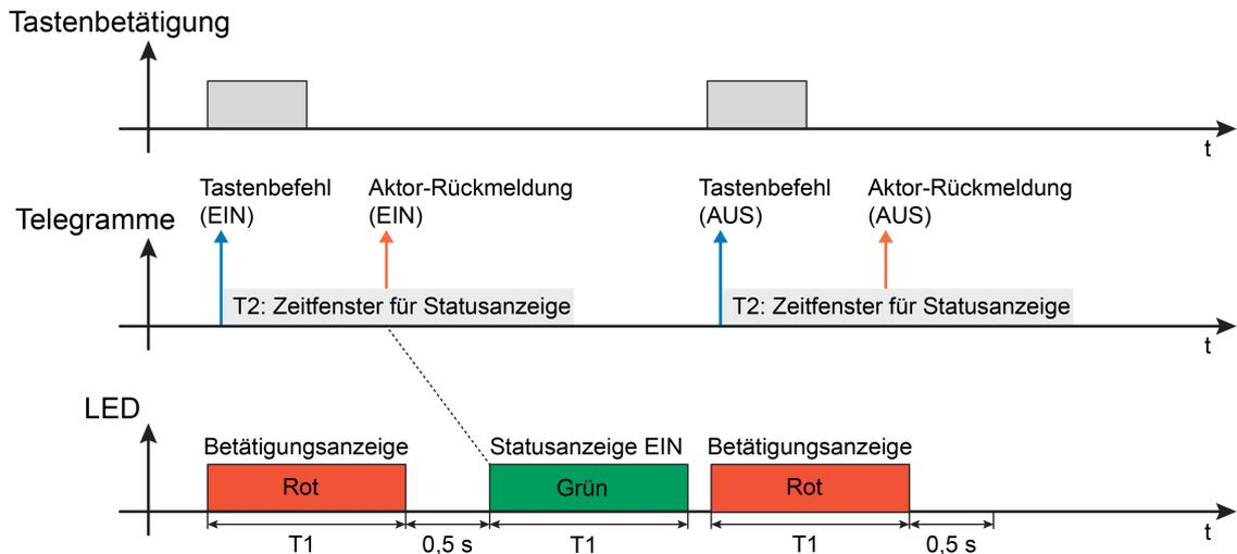
Bild 3: Beispiel einer 2-stufigen Betätigungs- und Statusanzeige mit Einfachstatus
