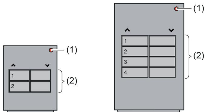
Bild 1: Geräteaufbau Handsender 2fach (links) und 4fach (rechts)
