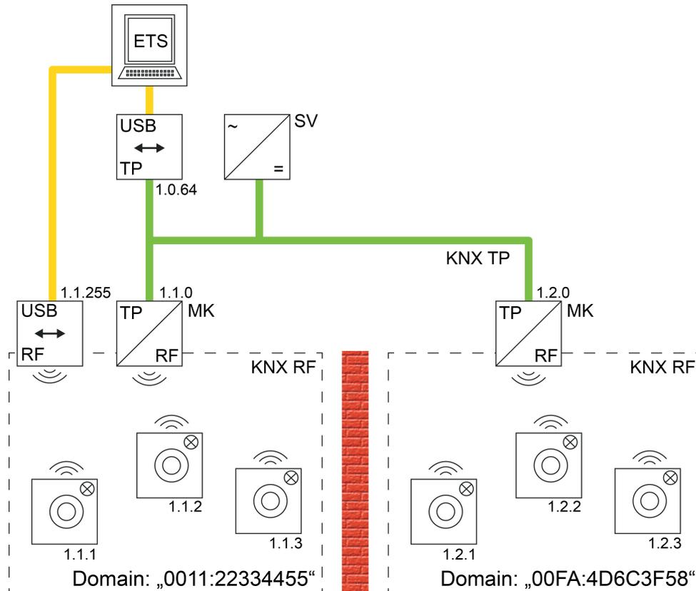
Bild 39: Beispiel einer möglichen KNX-Topologie mit zwei RF-Linien und Kopplung über eine TP-Hauptlinie (Beispiel)
