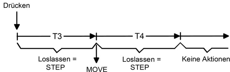
Bild 15: Bedienkonzept "Lang – Kurz oder Kurz"
