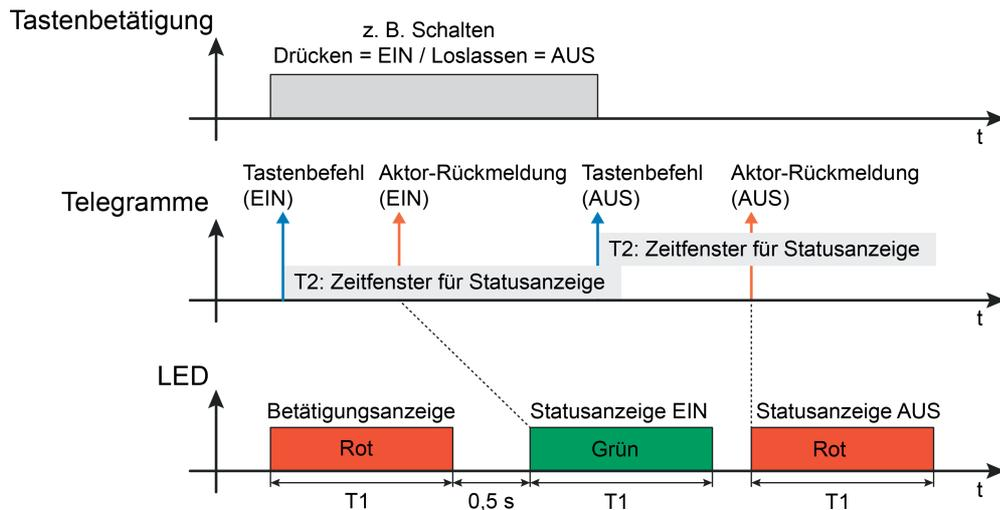
Bild 5: Beispiel einer 2-stufigen Betätigungs- und Statusanzeige mit Doppelstatus
