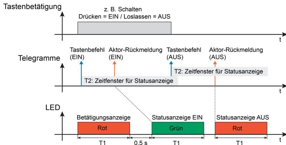
Bild 12: Beispiel einer Statusanzeige der Bedienfunktion "Schalten" mit Doppelstatus (EIN und AUS) Telegramm beim Drücken und Loslassen der Taste
