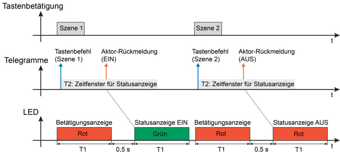
Bild 19: Beispiel einer Statusanzeige der Bedienfunktion "Szenennebenstelle"
