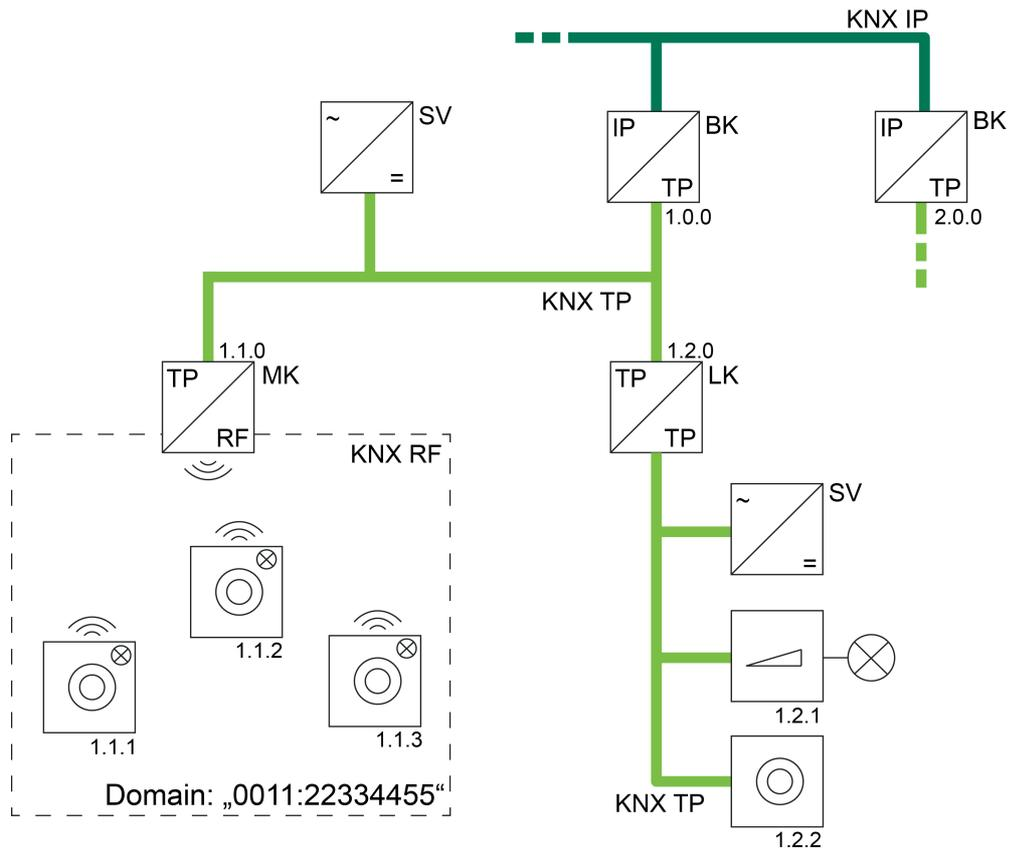
Bild 37: Beispiel einer möglichen KNX-Topologie mit RF-, TP- und IP-Linien
