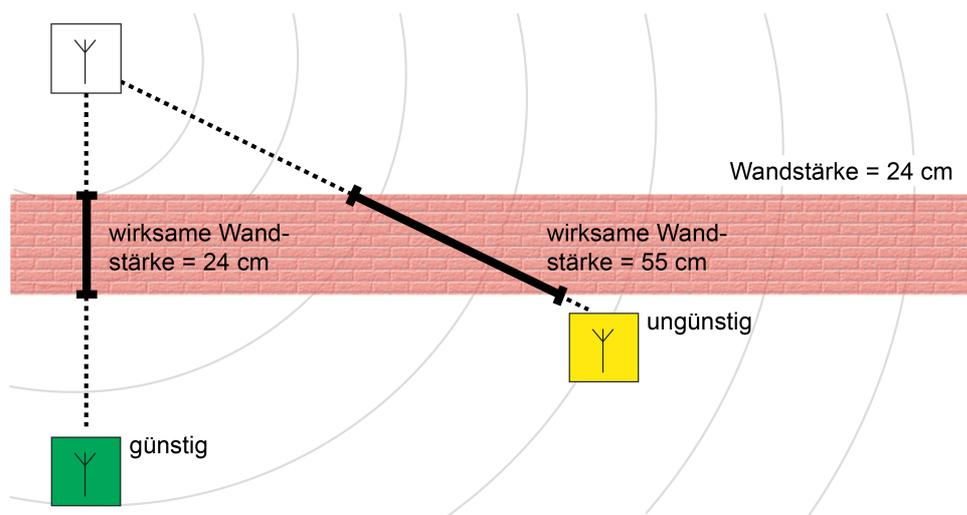
Bild 27: Dämpfung durch wirksame Wand- oder Deckenstärke
