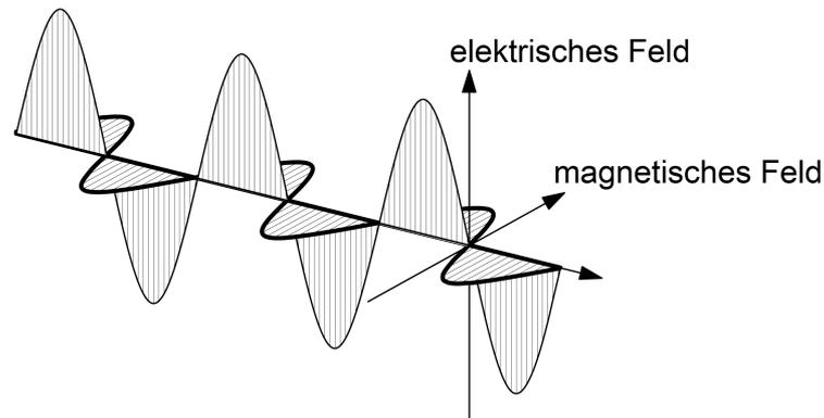
Bild 23: Modellvorstellung einer elektromagnetischen Welle im freien Raum
