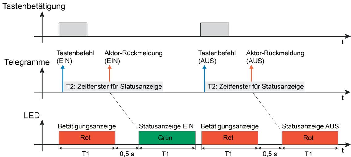
Bild 4: Beispiel einer 2-stufigen Betätigungs- und Statusanzeige mit Doppelstatus
