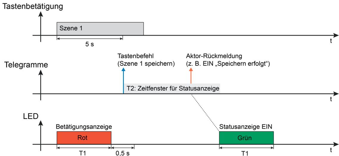
Bild 20: Beispiel einer Statusanzeige der Bedienfunktion "Szenennebenstelle"
