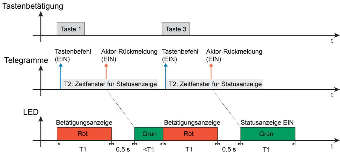
Bild 9: Beispiel einer 2-stufigen Betätigungs- und Statusanzeige
