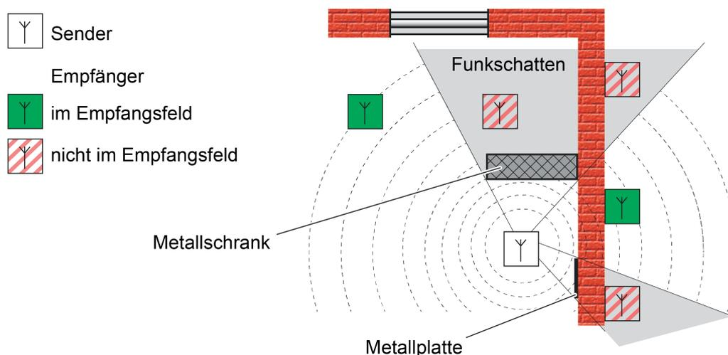
Bild 28: Funkshadow in einem Gebäude durch Metallteile (idealisiert)
