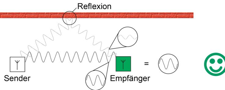
Bild 29: Interferenz beim Empfänger wirkungslos
