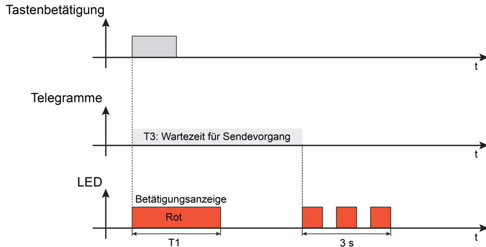
Bild 10: LED-Anzeige bei einem Übertragungsfehler
