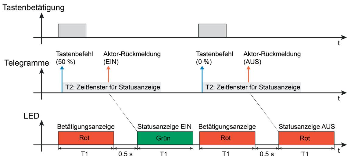
Bild 18: Beispiel einer Statusanzeige der Bedienfunktion "Wertgeber 1 Byte" mit Doppelstatus (EIN und AUS)
