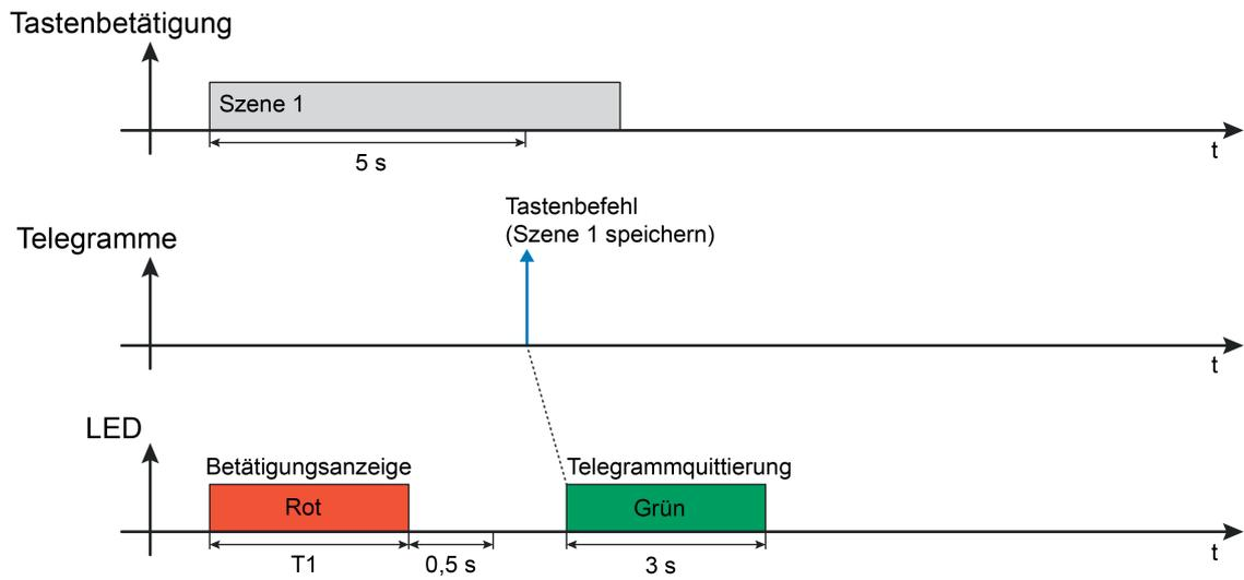
Bild 21: Beispiel einer LED-Anzeige der Bedienfunktion "Szenennebenstelle"
