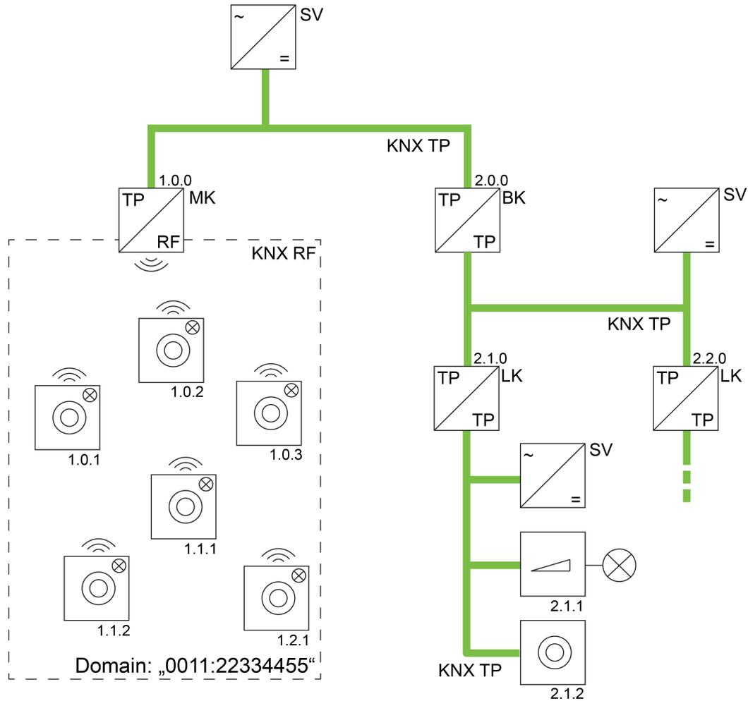
Bild 38: Beispiel einer möglichen KNX-Topologie mit RF- und TP-Linien
