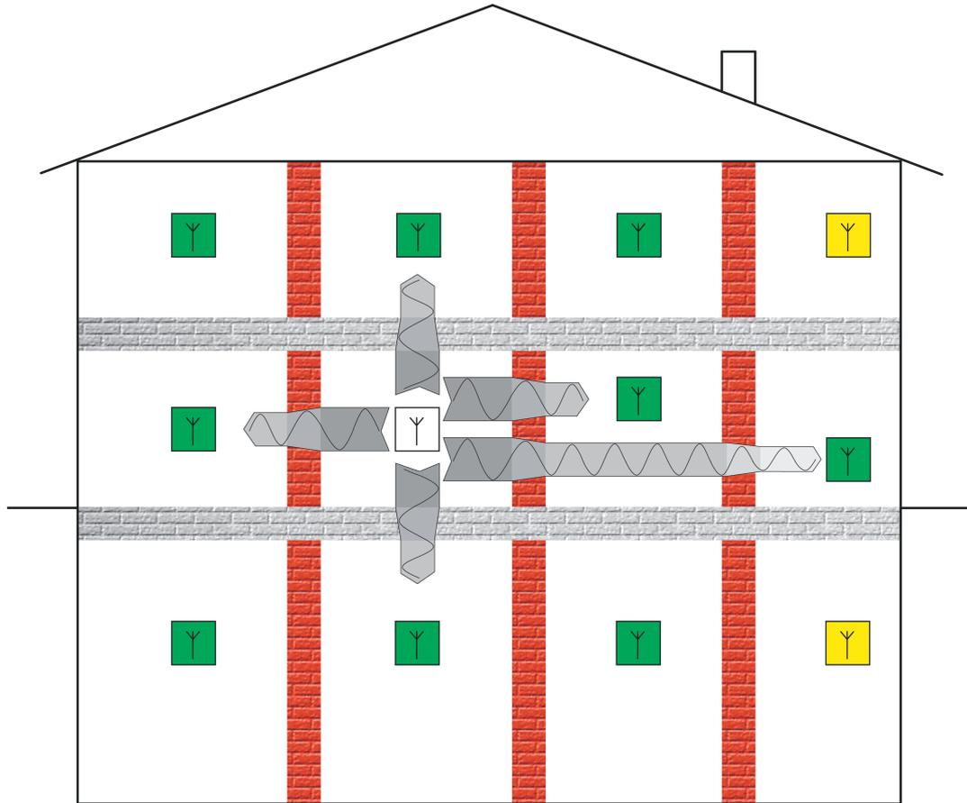
Bild 26: Dämpfung des Funksignals in Gebäuden durch Wände und Decken
