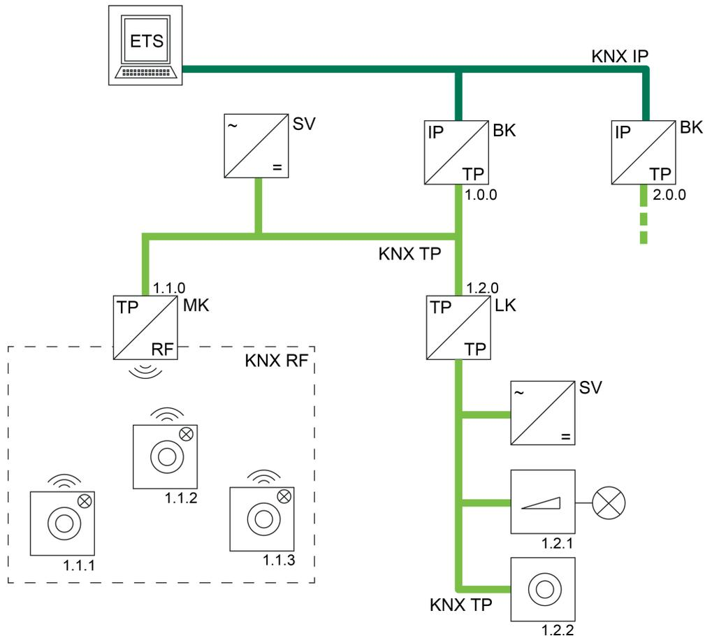
Bild 42: Beispiel einer möglichen KNX-Topologie mit einer KNX IP-Verbindung der ETS (KNX/net IP)
