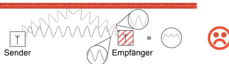
Bild 30: Interferenz beim Empfänger verhindert Empfang
