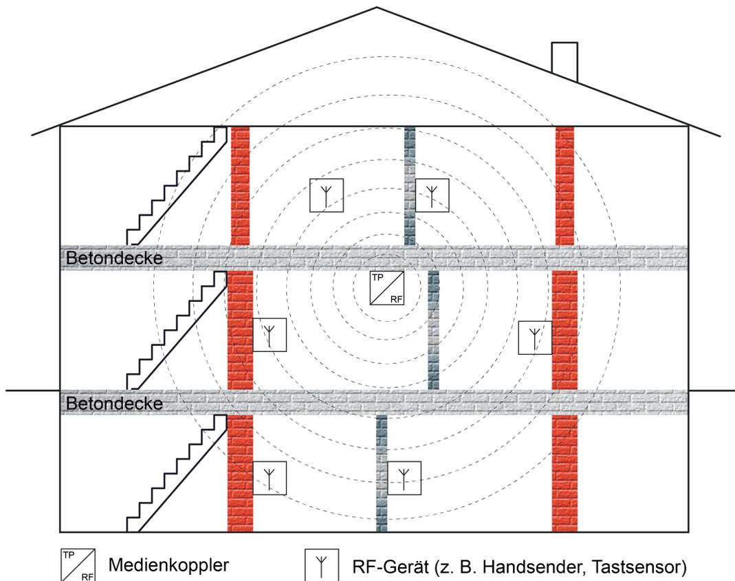
Bild 32: Gebäudestruktur mit einer KNX RF Linie (Beispiel)
